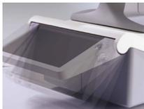
Ergonomischer, schwenkbarer Multitouch-Bildschirm
